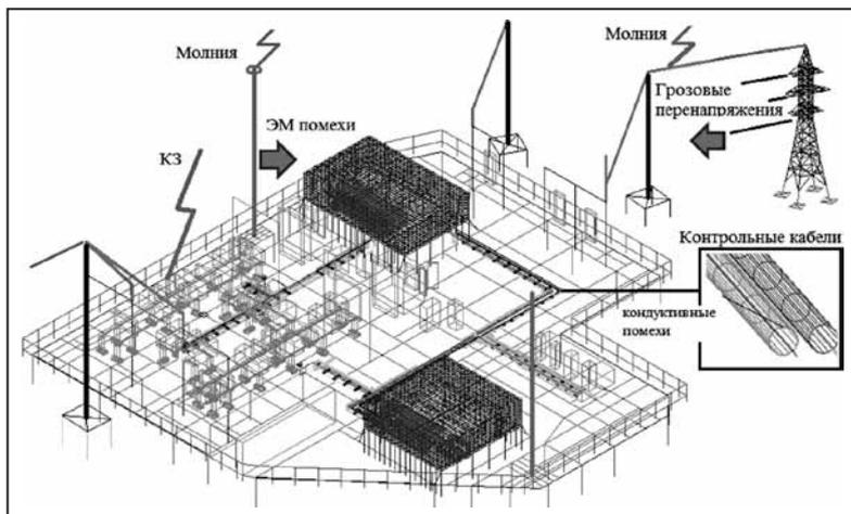
Рис.4. Геометрическая модель электрической подстанции и внешние воздействия
