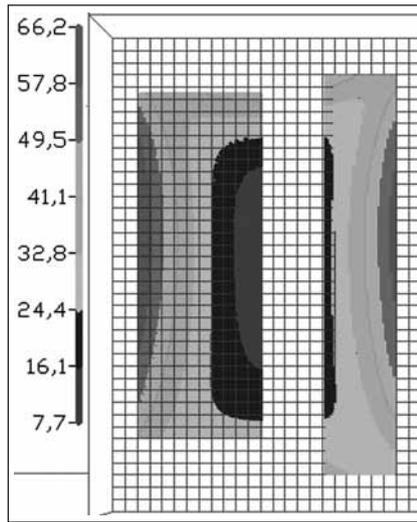
Рис.8. Распределение напряженности магнитного поля в местах расположения микропроцессорных систем управления с учетом экранирования при ударе молнии
