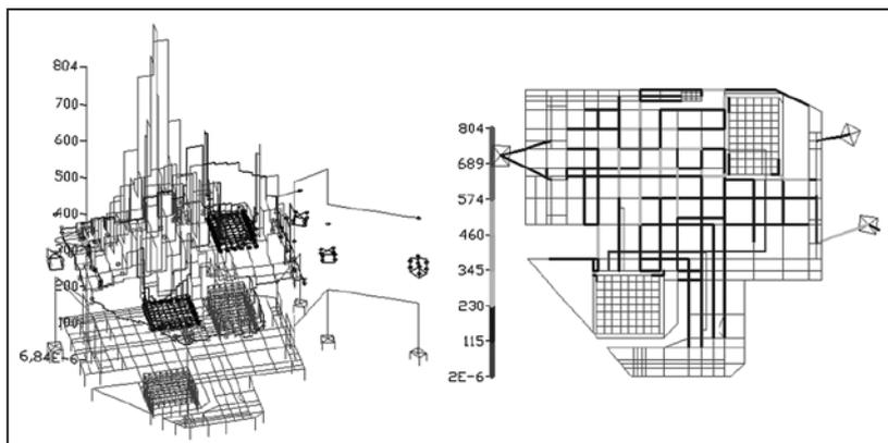
Рис.5. Распределение тока на электрической подстанции при КЗ (два варианта изображения)
