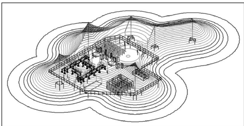
Рис.7. Зоны защиты электрической подстанции от удара молнии
