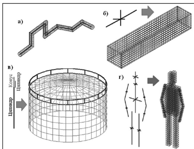
Рис. 2. Поддержка в геометрическом моделировании, создание сеток: кабель (а), экран (б), резервуар (в), модель человека (г)
