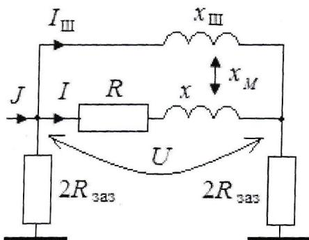
Рис. 3. Схема замещения кабеля с двусторонним заземлением экрана и шиной
