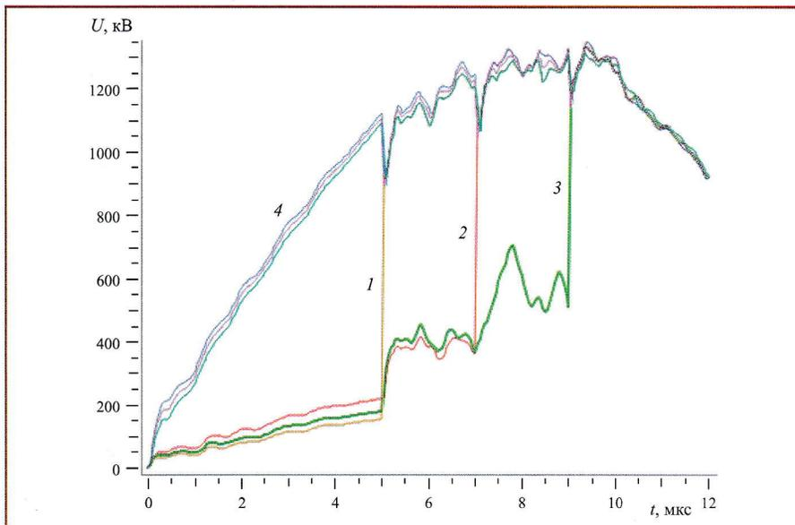
Рис. 3. Напряжение проводов ВЛ при ударе молнии с током 100 кА, 10/350 мкс с линейным фронтом в вершину опоры:
