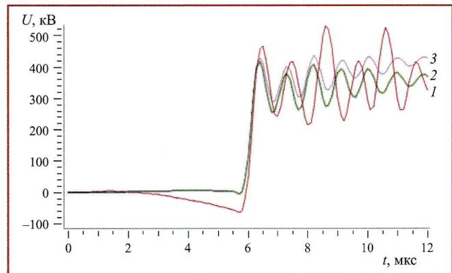
Рис. 6. Напряжение силового трансформатора, вызванное ударом молнии в вершину опоры ВЛ (рис. 1) с перекрытием изоляции, при использовании:
