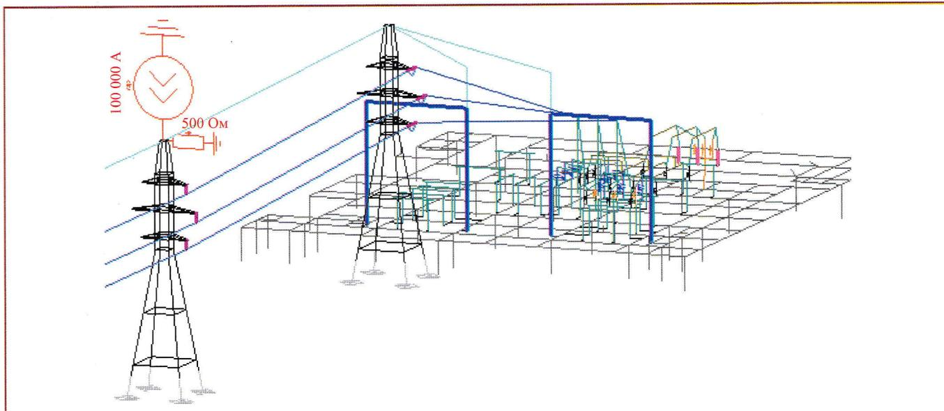
Рис. 1. Расчётная модель подстанции 150/10 кВ и ВЛ (три опоры ВЛ не показаны)
