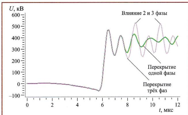
Рис. 5. Напряжение силового трансформатора при обратном перекрытии изоляции одной и трёх фаз воздушной линии
