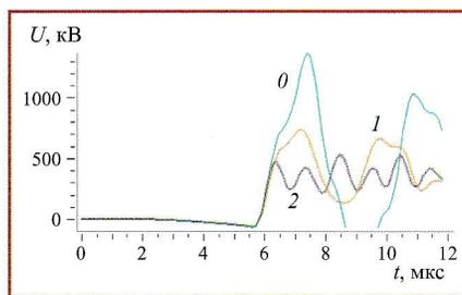
Рис. 4. Напряжение силового трансформатора (относительно заземлителя), вызванное ударом молнии в вершину опоры ВЛ (рис. 1) с перекрытием изоляции:
