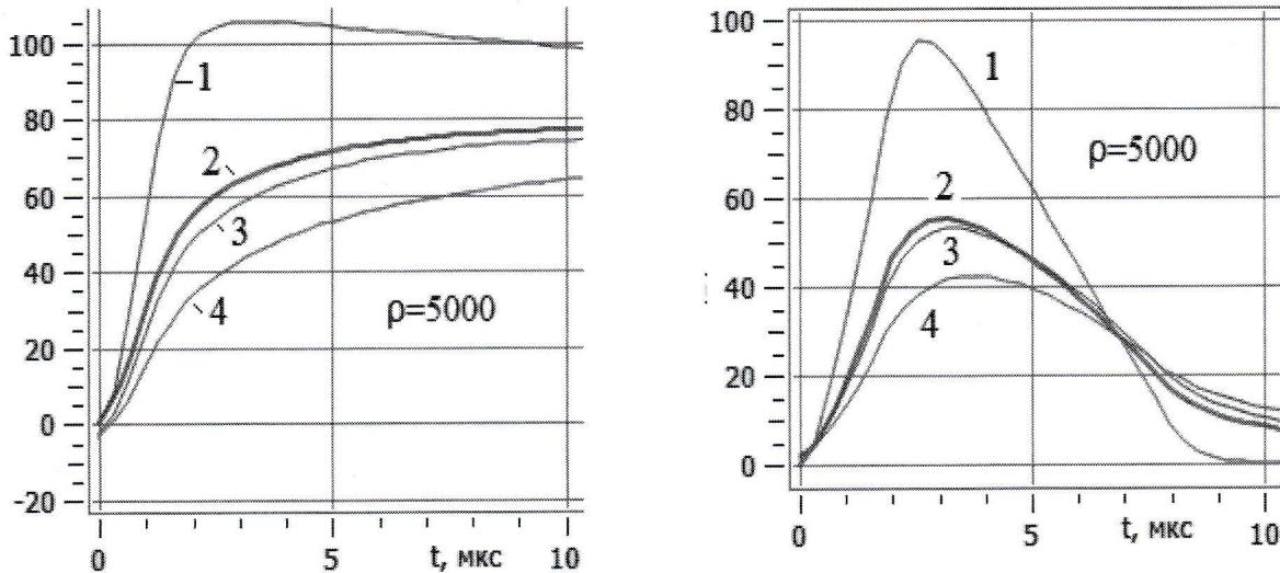
Рис. 6. Потенциал в центре заземлителя (описание рис. 5) при вводе импульса тока амплитудой 1 А с линейным фронтом, длительностью 1.2/50 мкс в грунте с удельной проводимостью: 1 –  $\sigma=\text{const}$ ; 2 –  $\sigma(j\omega)$  по Мессириу, расчет по методу Влаха, 3 –  $\sigma(j\omega)$  по Мессириу, расчет частотным методом, 4 –  $\sigma(j\omega)$  по Висакро-Алипио, расчет частотным методом;  $\epsilon_r = 10$
