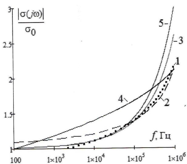
Рис. 2. Частотная зависимость модуля удельной проводимости грунта по модели: 1 – Скота, 2 – Смита-Лонгмаера, 3 – Мессира, 4 – Висакро-Портела, 5 – Висакро-Алипио при  $\sigma_0 = 1 \text{ мСм}/\text{м}$
