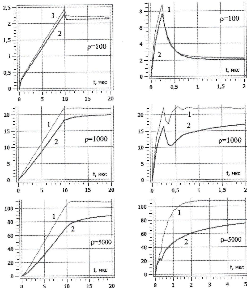
Рис. 5. Потенциал в центре заземлителя ( $20 \times 20 \text{ м}$ , шаг сетки  $5 \text{ м}$ , стержни стальные,  $\mu_r = 200$ , диаметр  $20 \text{ мм}$ , глубина погружения  $1 \text{ м}$ ) при вводе импульса тока амплитудой  $1 \text{ А}$  с линейным фронтом, длительностью:  $10/350 \text{ мкс}$  (графики слева) и  $0.25/100 \text{ мкс}$  (графики справа) в грунте с удельной проводимостью: 1 –  $\sigma = \text{const}$ , 2 –  $\sigma(j\omega)$  по Мессириу,  $\epsilon_r = 10$ .
