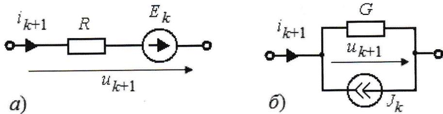
Рис. 4. Дискретная модель индуктивности (а) и емкости (б) на  $k$ -временном шаге
