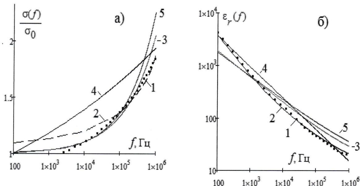
Рис. 1. Частотная зависимость относительной удельной проводимости (а) и относительной диэлектрической проницаемости (б) по модели грунта: 1– Скотта, 2– Смита-Лонгмаера, 3– Мессира, 4– Висакро-Портела, 5– Висакро-Алипио при  $\sigma_0=1$  мСм/м
