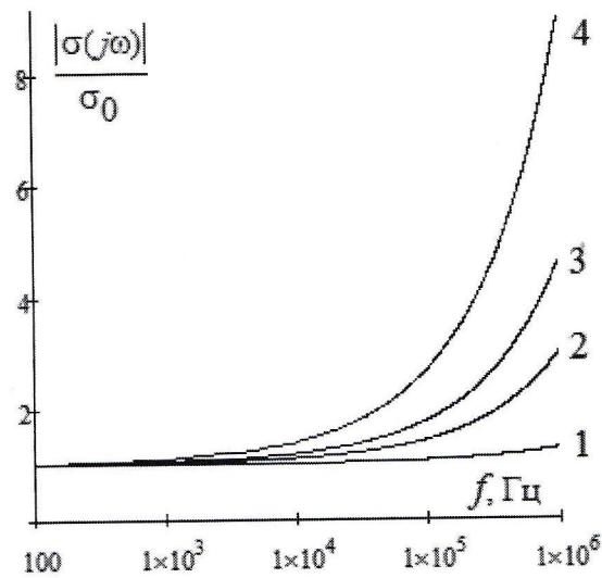
Рис. 3. Частотная зависимость модуля удельной проводимости грунта по модели Висакро-Алипио при: 1 –  $\sigma_0 = 10 \text{ мСм}/\text{м}$ , 2 –  $\sigma_0 = 1 \text{ мСм}/\text{м}$ , 3 –  $\sigma_0 = 0.5 \text{ См}/\text{м}$ , 4 –  $\sigma_0 = 0.2 \text{ мСм}/\text{м}$
